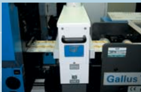
One of the 28 IST UV dryer set up on the Gallus line. Uno de los 28 módulos de lámpara UV de IST en las máquinas Gallus.
