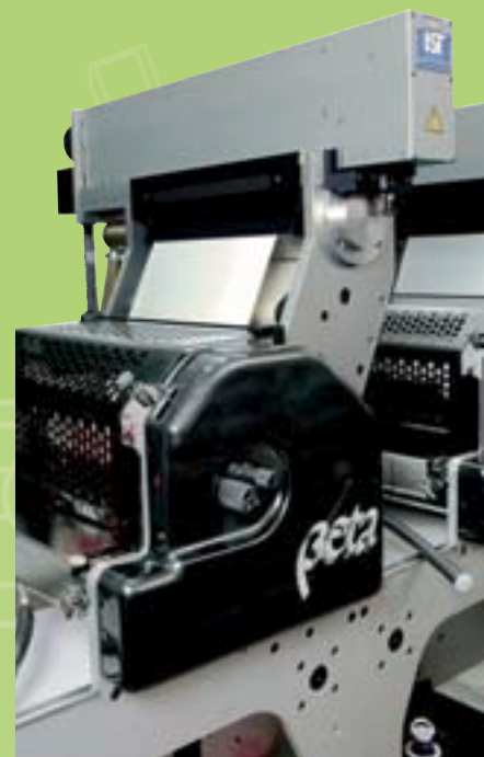
Edale Beta, flexo printing press with IST lamp modules. Máquina de imprimir flexo Beta con módulos de lámpara IST.
