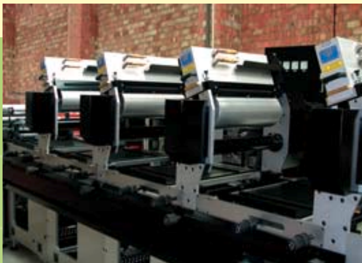
Edale Sigma 510, 4-colour printing press with IST BLK® lamp modules. Máquina de imprimir flexo Edale Sigma 510 (4 colores) con módulos de lámpara IST BLK®
