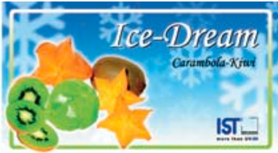
Druckbeispiel: Inmould-Eislabels, Stärke 65 µm, Inline-Produktion mit 2 UV-Zwischentrocknungen (sauerstoff-reduziert) und 2 UV-Endtrocknungen Print sample: In-mould ice-cream labels, thickness: 65 µm, in-line production with 2 UV interdeck units (oxygen-reduced) and 2 UV end-of-press units.
